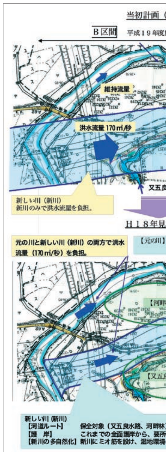
検討の結果、「2way方式」による整備が採用されたB区間。新河道は河畔林や又五良水路を保全するとともに、周辺地形と調和させるため曲線的なルートに変更された
